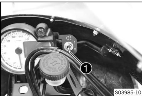
Der Rücklichtschalter **1** ist rechts neben dem Kombiinstrument angebracht.
