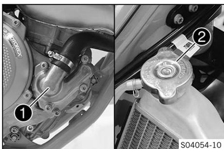
Durch die Wasserpumpe ① im Motor ist ein Zwangsumlauf der Kühlflüssigkeit gegeben.
